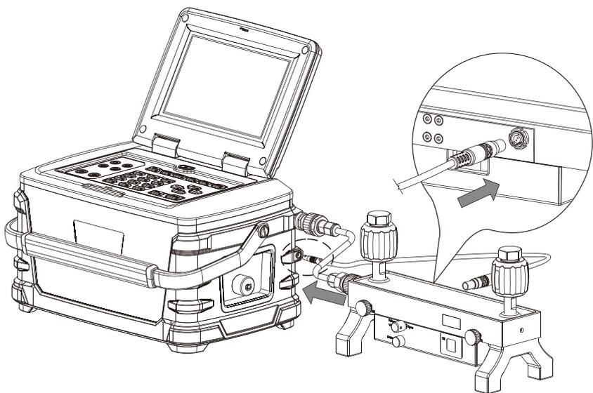
3. 将被检仪器仪表安装在连接台的快接头中；
