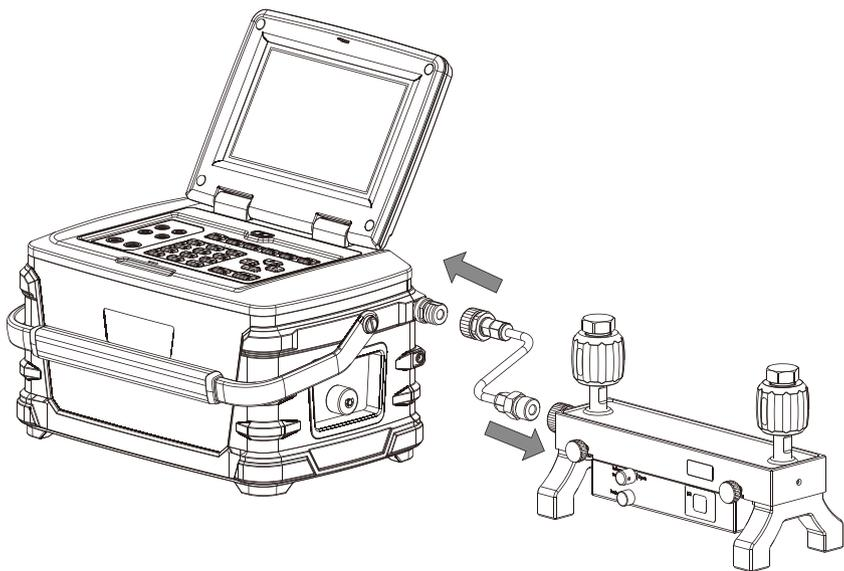
2. 使用回零通讯线将连接台ConST104H与液压版811A进行电气连接；
