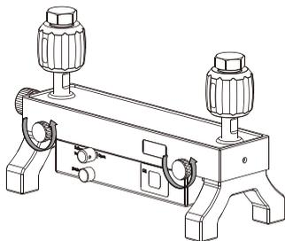
3. 将集液箱向箭头拉动，直至集液箱从连接台基座上完全卸下；
