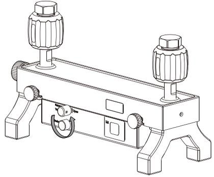
3. 打开集液箱通气螺母，此时集液箱排液螺母开始向外排液；
