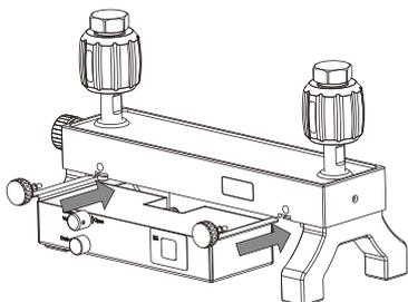
5. 分别顺时针旋转两个集液箱限位把手，使其螺纹旋入连接台，并能够压住集液箱的两侧位置即可。
